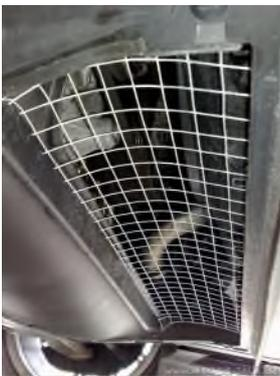
Beispiel: Drahtgitter unter dem Motorraum einbauen (Fragen Sie gegebenenfalls in der Autowerkstätte nach, ob dies bei Ihrem Fahrzeug möglich ist)
