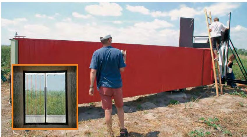
*Eine Serie der im Flugkanal von Hohenau getesteten Scheiben mit Mustern.*
