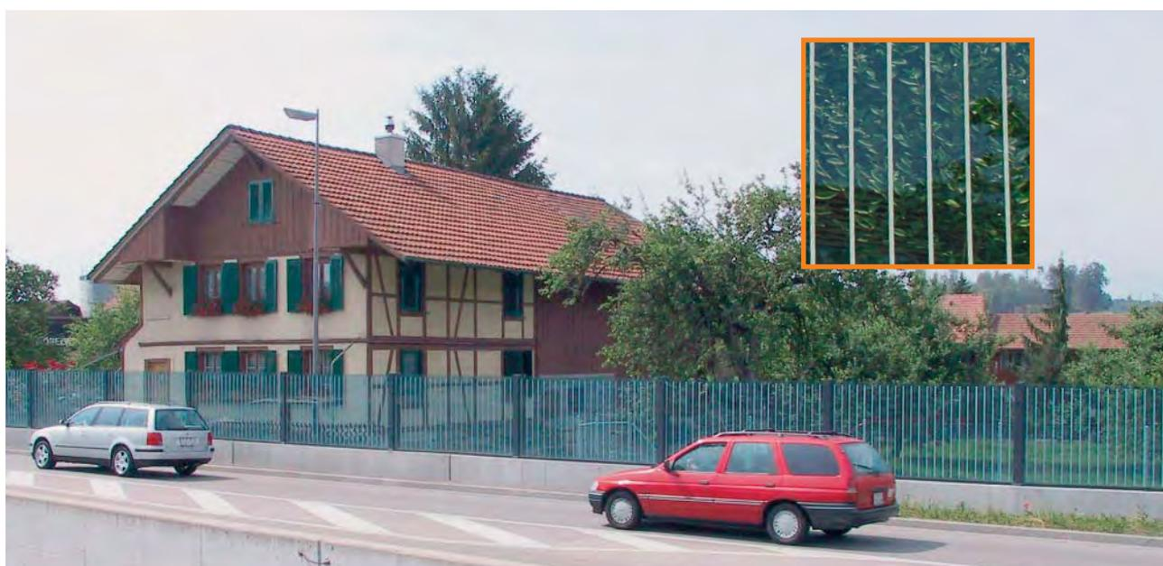
*Aufgrund einer nationalen Lärmschutzverordnung wurden in der Schweiz in den letzten Jahren unzählige Laufkilometer von Schallschutzwänden realisiert. Bei transparenten Abschnitten sind Vogelschutzstreifen längst bewährter Standard.*
