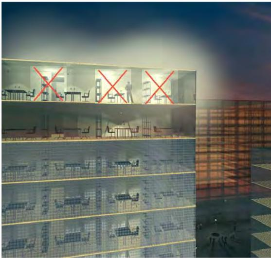
Nächtlich benutzte Büros: Möglichst Markisen runterlassen (unten) oder mindestens auf Arbeitsplatz fokussiertes Licht (Mitte) verwenden. Die Ausleuchtung wie oben ist möglichst zu vermeiden.
