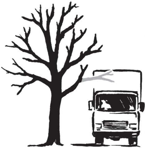
Korrektur Lichtraumprofilschnitt bei Ästen über 10 cm Durchmesser (Schnitt auf Versorgungsast)
